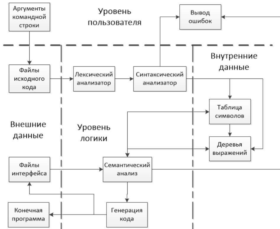
Рисунок 1 – Схема архитектуры компилятора
