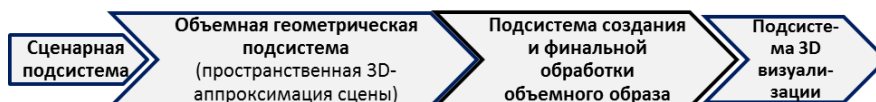
Рисунок 6 – Основные этапы синтеза 3D- объемного изображения методами создания 3D- визуального образа сцены в трехмерной видеопамяти 3D- дисплея
