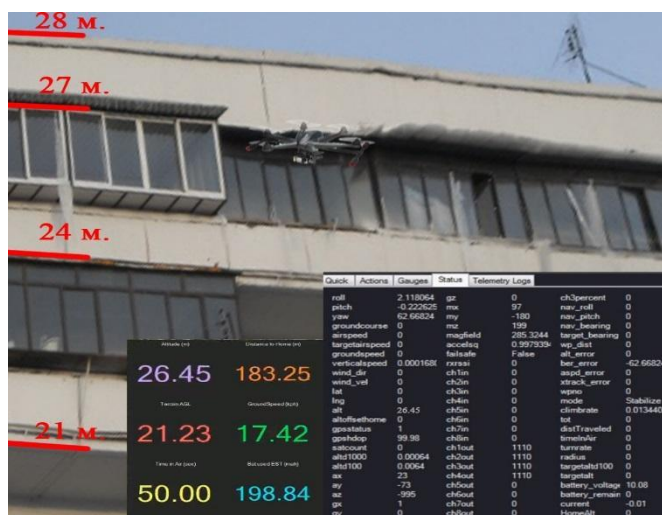
Рисунок 6 – Корректные показания барометра после компенсации
