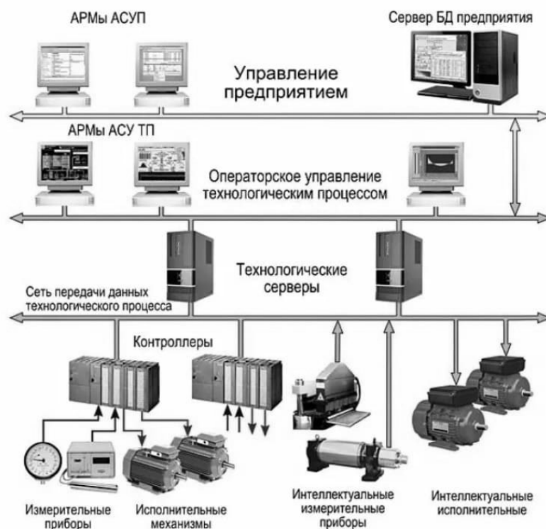
Рисунок 2 – Типичная структура систем управления производством
